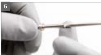
5 Farbnadel im Bereich der Nadeldichtung einfetten
