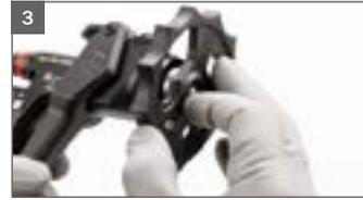
3 Zum Schluss wird mit dem im Universalschlüssel integrierten Ringschlüssel die Farbdüse ausgeschraubt.
