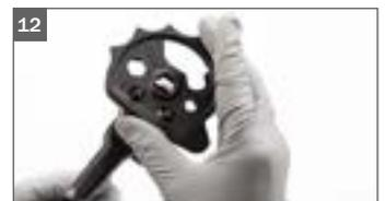
12 Luftdüse mit dem Universalschlüssel ausrichten (optional)
