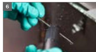
Vor allen Wartungs- und Reinigungsarbeiten, Lackierpistole vom Druckluftnetz abkoppeln. Neutrale Reinigungsmittel (pH-Wert 6 bis 8) verwenden. Lackierpistole nicht in Reinigungsmittel einlegen.
