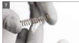
7 Farbnadelfeder einfetten und einsetzen
