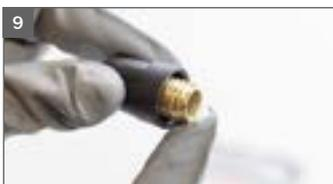
9 Gewinde der Materialmengenregulierschraube einfetten
