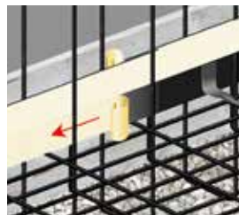
Abziehen der Schutzfolie
