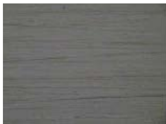
Finition traditionnelle après scrub test (essai de résistance aux frottements). Herkömmliche Decklackierung nach Scheuertest
